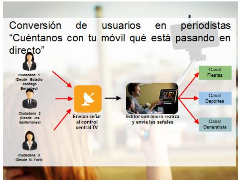
Figura 4. Proceso de envío de señal desde la app hasta el control central de TV donde se reparte la señal a distintos canales
